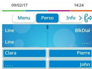
Benutzerschnittstelle mit virtueller Erweiterung. Vier programmierbare Funktionstasten werden angezeigt, die als intelligentes Zusatzmodul verwendet werden können.
