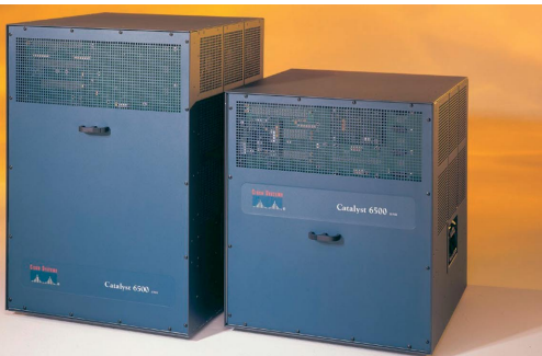
Im Backbone wurden auf der Primärebene fünf „Primäre Konzentrationspunkte“ (PKP) mit Cisco-Switches der Produktfamilie Catalyst 6509 installiert
